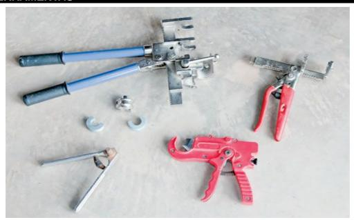
Kit de instalação de tubulação PEX composto por alicate de corte de tubos, alicate alargador de tubos e prensa de conexão.
