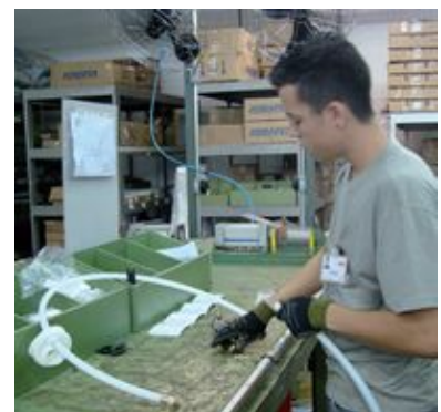
Figura 6 - Chicote sendo produzido na fábrica
