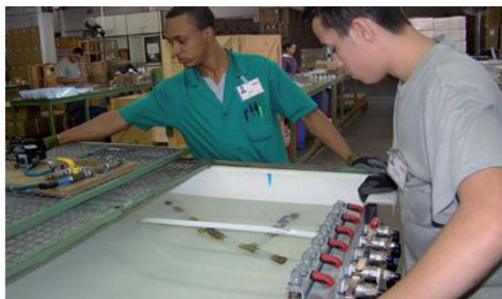
Figura 10 - Para garantir a ausência de vazamentos, testes de estanqueidade são realizados
