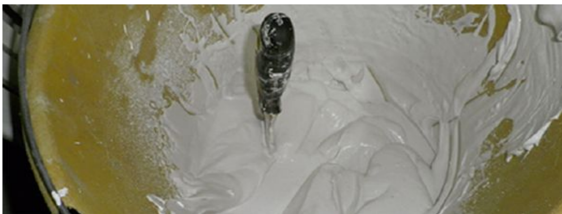
Figura 3 - Consistência pastosa da mistura do gesso cola após o preparo com mistura mecânica na obra
