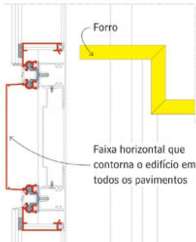
**Conexão da fachada e pilares**
