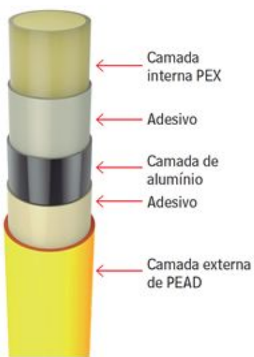
Figura 1 - Composição do tubo PEX multicamada
