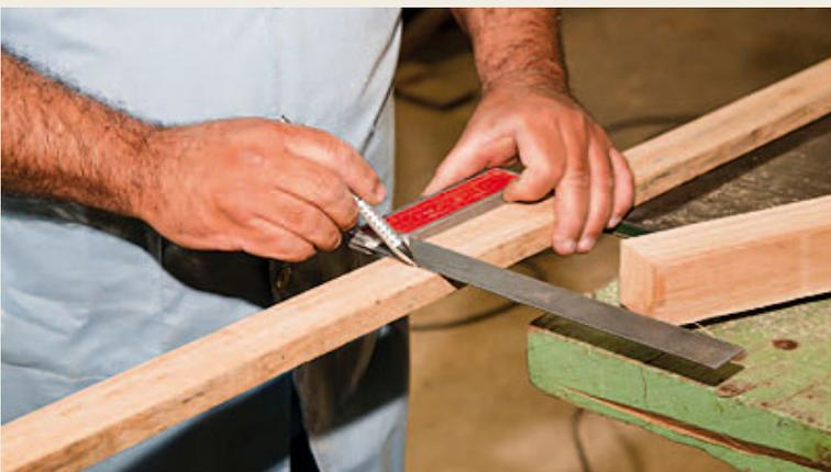
**3** Use o esquadro para se certificar de que a linha de corte está perfeitamente perpendicular ao comprimento do sarrafo.
