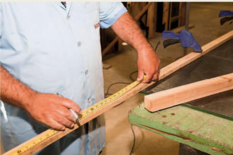
**2** Fixe o sarrafo na borda da chapa com grampos de aperto (sargentos) em pelo menos dois pontos, para dar maior firmeza. Depois, marque com um lápis onde a peça deverá ser cortada.
