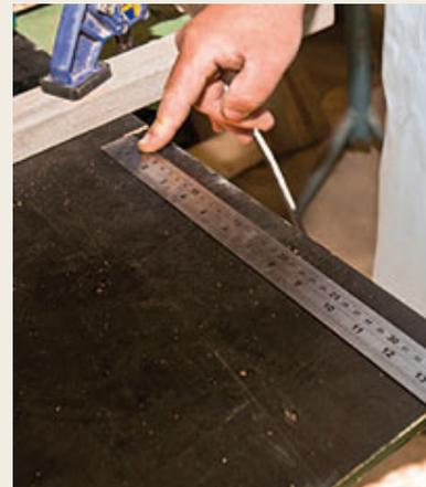
A lâmina de corte fica a 2,5 cm da borda desta serra manual. Para saber a largura real da peça, ou seja, o ponto em que a chapa será cortada de fato, desconte esse valor da distância entre a extremidade da chapa e o sarrafo-guia.
