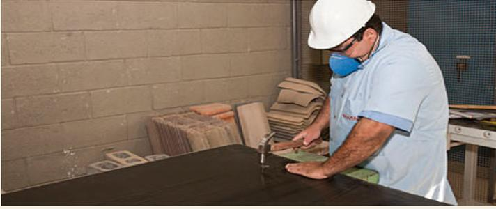
**7** Antes de executar o corte da chapa de madeira compensada, fixe-a na bancada com pregos.
