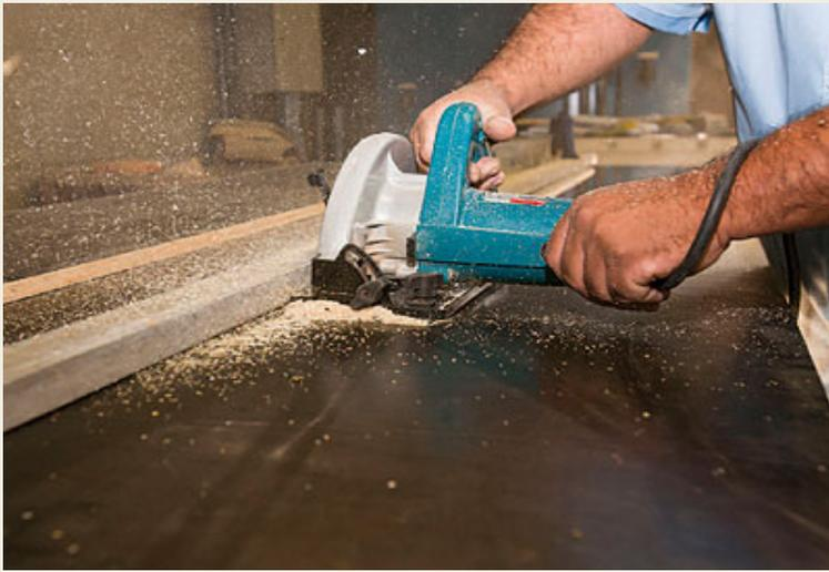
**9** Faça o corte da peça, cuidando para que o cabo de força não fique na frente da lâmina.
