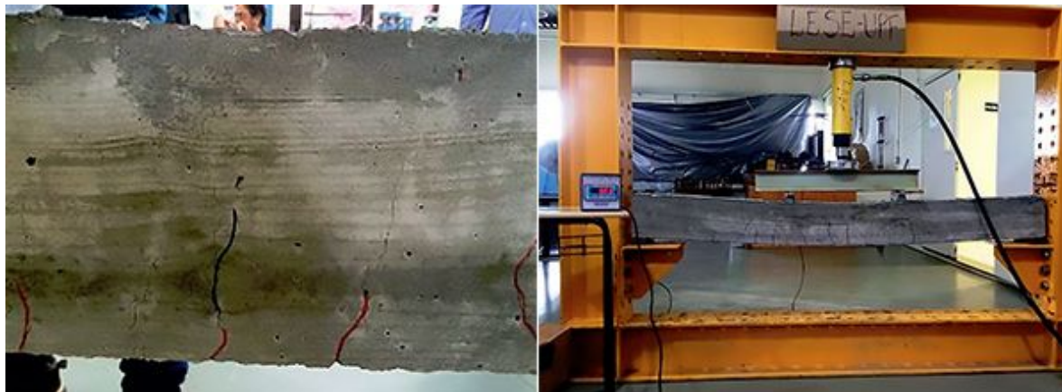
Figura 5 - Desenvolvimento da fissuração
