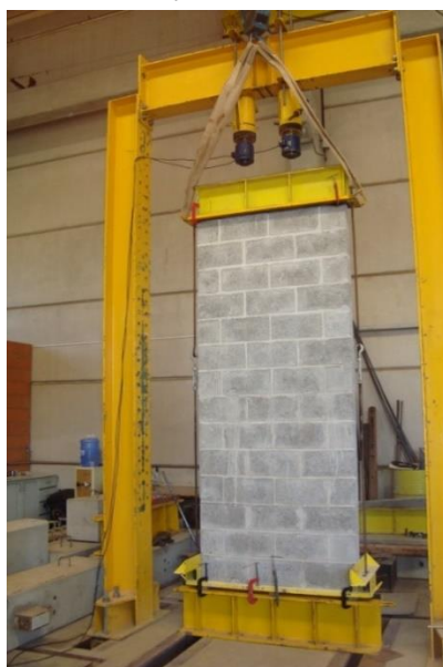
Figura 4 - Parede posicionada no pórtico de reação
