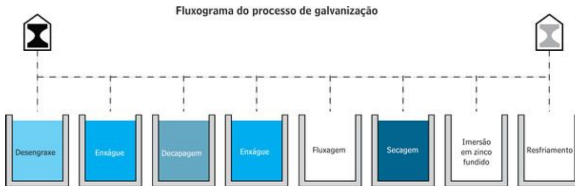
Figura 4 - Fluxograma do processo de galvanização
