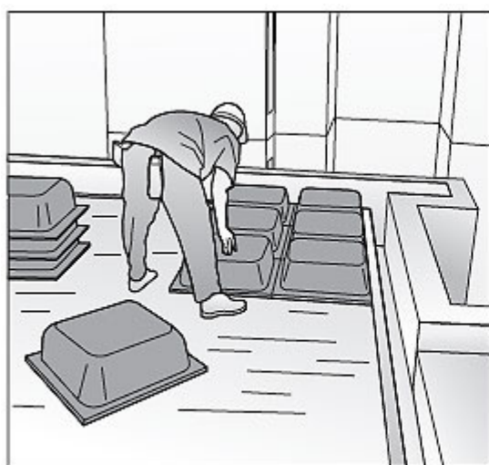
Fôrmas apoiadas sobre painéis de compensado
