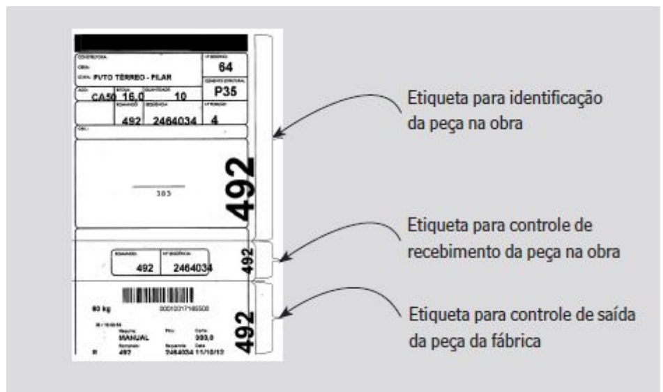
Figura 4 - Exemplo de etiqueta de identificação das peças de aço cortado e dobrado
