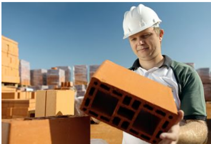
Os blocos estruturais de cerâmica são usados principalmente em obras no Rio Grande do Sul. A resistência desse material geralmente varia de 3 MPa até 18 MPa.
