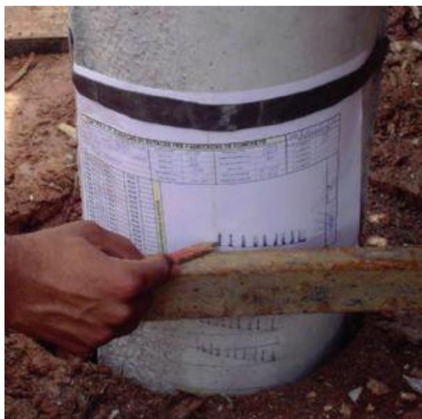
O Pile Integrity Test (PIT) é um ensaio dinâmico de baixa deformação que, apesar de apresentar algumas limitações, permite conhecer a integridade da estaca após a cravação. "Para estacas pré-moldadas é um ensaio que traz resultados bastante satisfatórios", acredita Correa.
