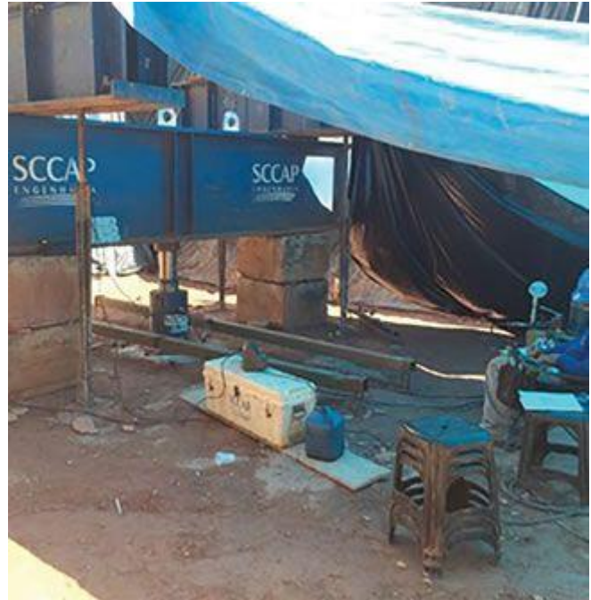
Ensaio de Prova de Carga Estática (PC1) realizada pela SCCAP Engenharia
