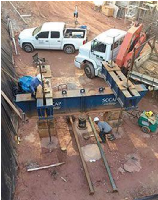
Prova de Carga Estática (PC1) realizada pela SCCAP: a vista aérea evidencia o posicionamento da estaca ensaiada e as estacas de reação
