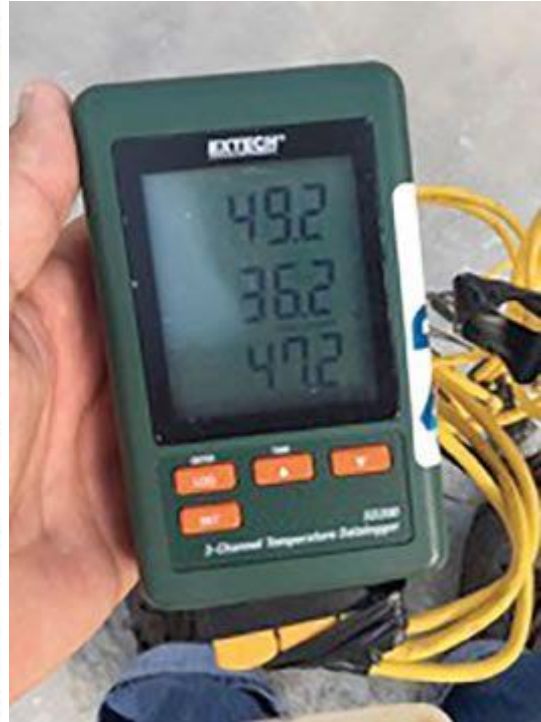
Equipamento empregado no monitoramento da temperatura do concreto
