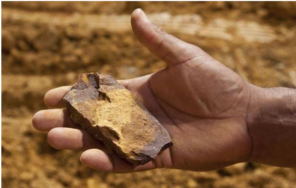
Solo do terreno apresenta ocorrências de limonita (minério de ferro), que formam lâminas bem duras, com camadas de 20 cm até 80 cm de espessura
