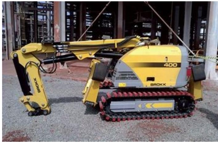
Figura 1- Vista geral do robô demolidor
