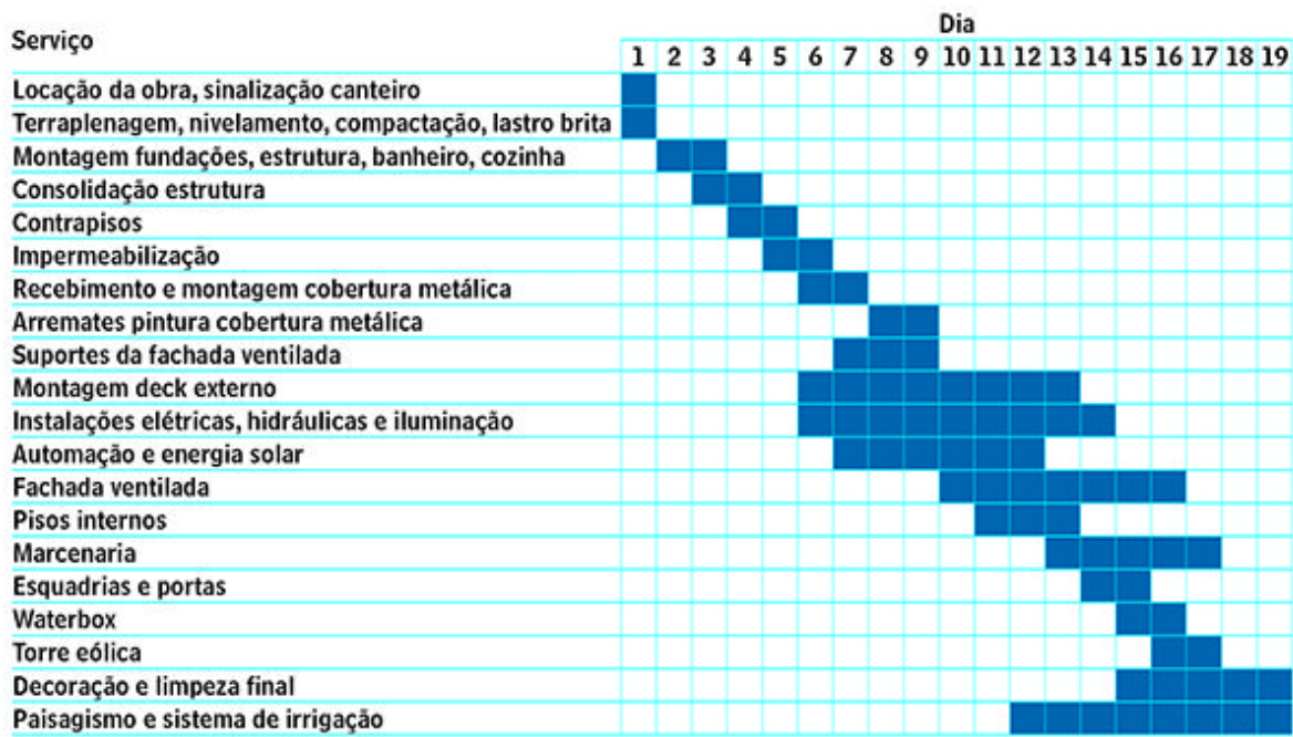
Cronograma diário no canteiro de obras da Casa Aqua apresentada
