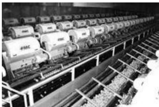
Figura 5.2 Extratores: equipamento que promove o esmagamento da fruta possibilitando a extração do suco.
