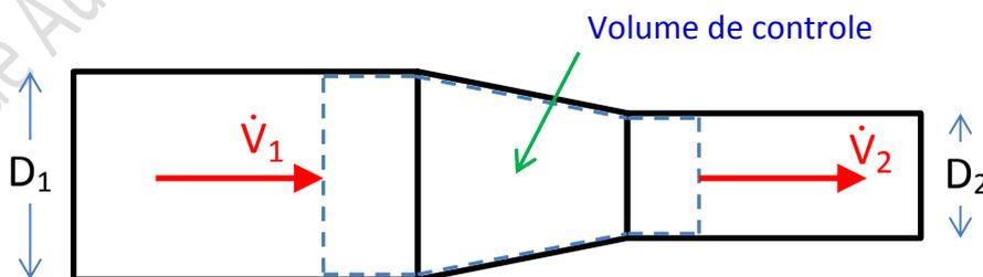
Dados:  $D_1 = 1 \text{ m}$ ;  $D_2 = 0,5 \text{ m}$ ;  $\dot{V}_1 = 0,1 \text{ m}^3/\text{s}$ ;  $\rho = 1 \text{ g/cm}^3$ ;  $\mu = 1 \text{ g/cm.s}$  [poise]. O fluido é incompressível.
