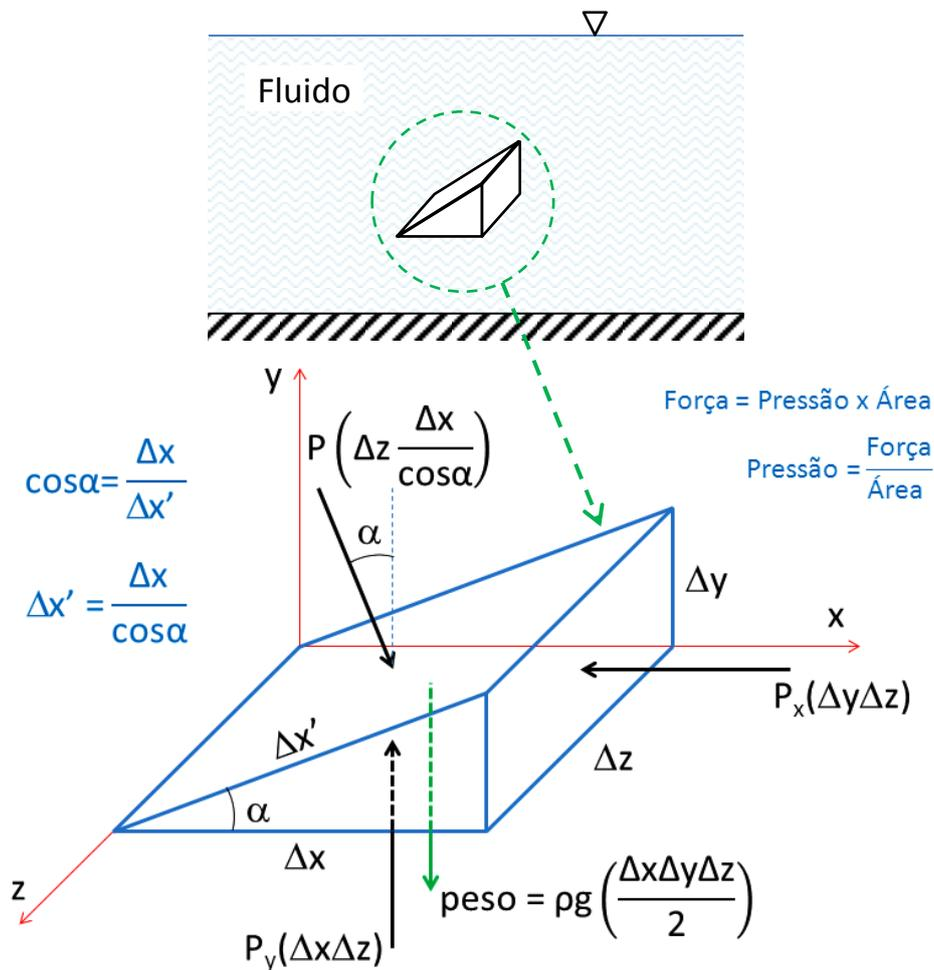
Direção x:  $P_x(\Delta y \Delta z) = P(\Delta x \Delta z) \left( \frac{\sin \alpha}{\cos \alpha} \right)$
