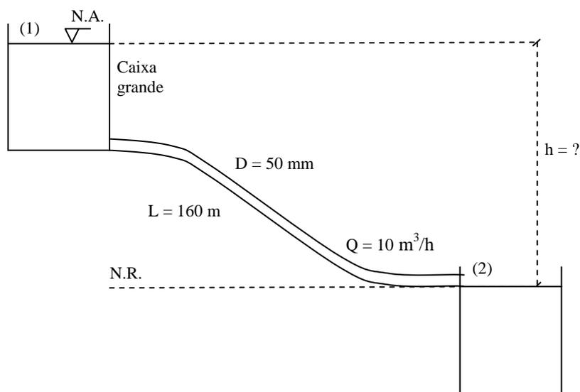
e.1) Qual o máximo desnível ( $h$ ) entre os dois reservatórios para garantir a vazão desejada?
