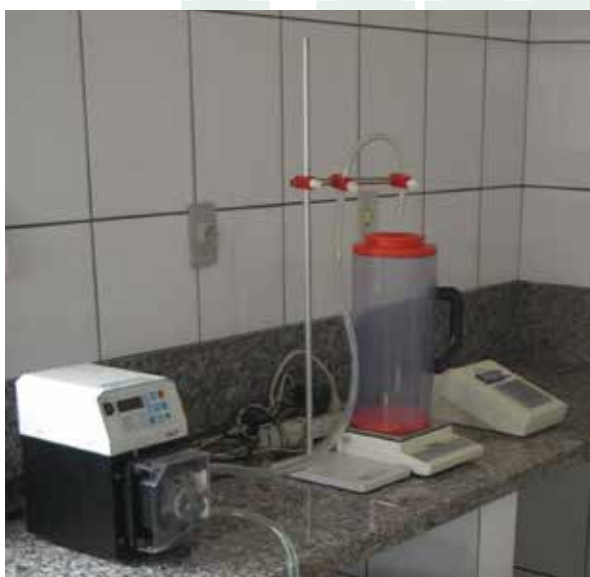
Foto 6 – Diluição automatizada do sêmen suíno.
