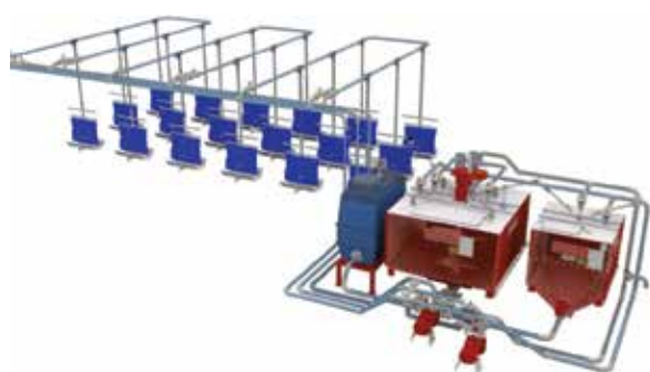
Figura 1 – Esquema de sistema de arraçamento de dieta líquida
