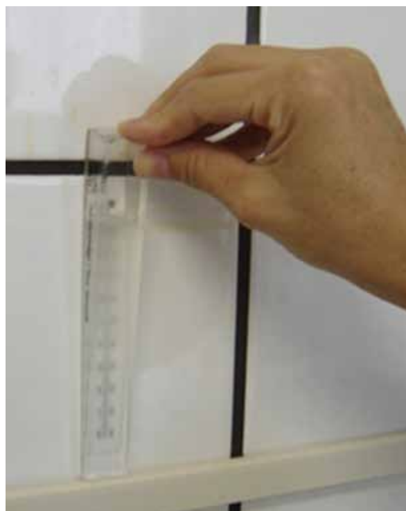
Foto 3 – Espermodensímetro de Karras
