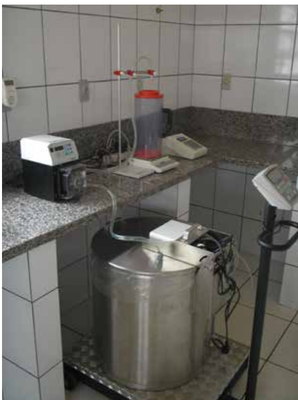
Foto 5 – Sistema automatizado de diluição do sêmen FONTE: ACERVO DOS AUTORES
