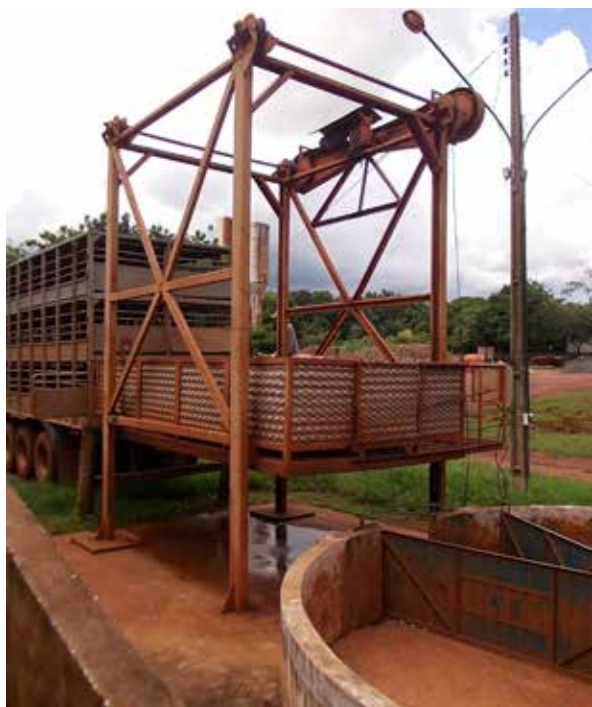
Foto 4 – Embarque dos suínos na granja, com utilização de plataforma móvel, facilita a condução dos animais em caminhões de três pisos
