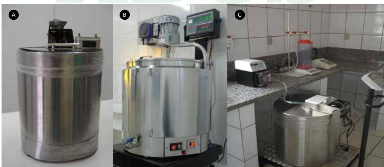
Foto 4 – Tanques de preparo de diluente
