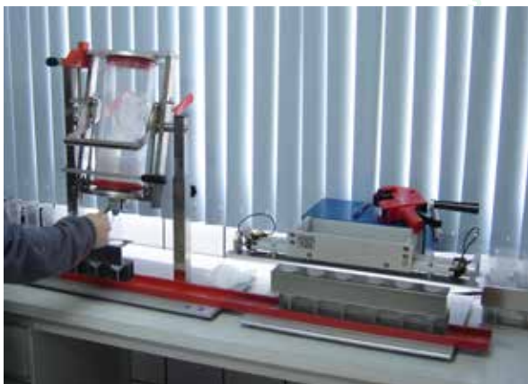
Foto 6 – Sistema semiautomático de fracionamento e envase de sêmen FONTE: ACERVO DOS AUTORES
