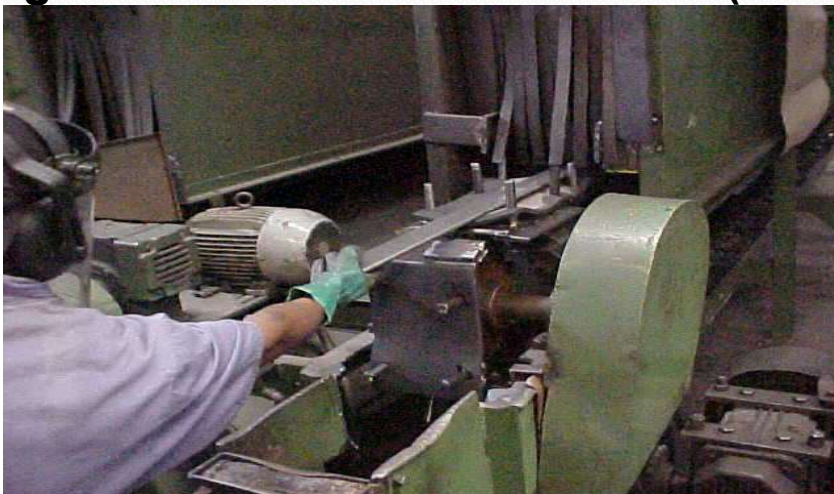
Esquema da realização do jateamento por granalhas – Feixe molas carro (lamina)
