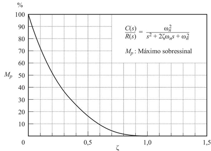
**Exemplo 5.1** Considere o sistema mostrado na Figura 5.6, onde  $\zeta = 0,6$  e  $\omega_n = 5$  rad/s. Obteremos o tempo de subida  $t_r$ , o tempo de pico  $t_p$ , o máximo sobressinal  $M_p$ , e o tempo de acomodação  $t_s$  quando o sistema for submetido a uma entrada em degrau unitário.
