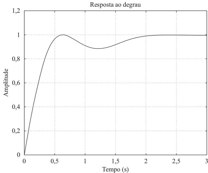
**A.5.9** Quando um sistema de malha fechada envolve uma dinâmica no numerador, a curva de resposta ao degrau unitário pode apresentar um grande sobressinal. Obtenha a resposta ao degrau unitário do seguinte sistema, utilizando o MATLAB:
