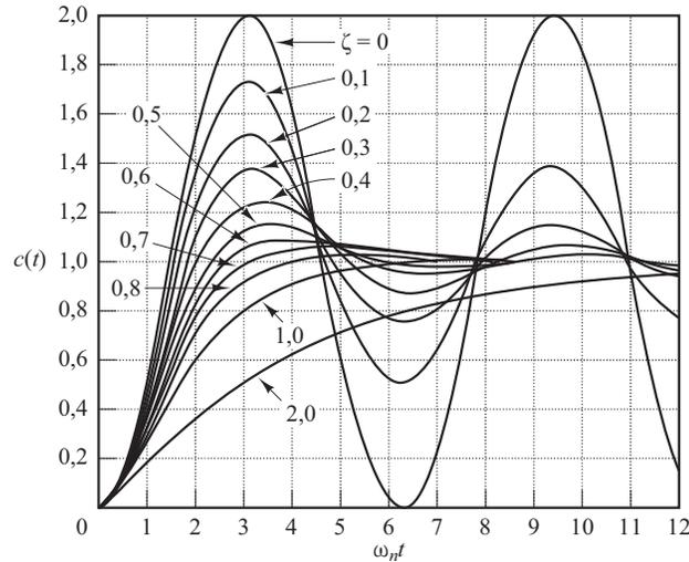
**Definição das especificações da resposta transitória.** Com frequência, as características de desempenho de um sistema de controle são especificadas em termos de resposta transitória a uma entrada em degrau unitário, já que se trata de entrada suficientemente brusca e gerada com facilidade. (Quando a resposta a uma entrada em degrau é conhecida, é possível calcular matematicamente a resposta a qualquer tipo de sinal de entrada.)
