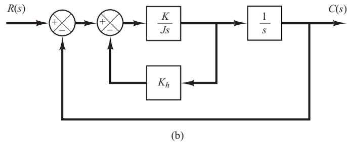
**B.5.24** Considere o servossistema com realimentação tacométrica mostrado na Figura 5.81. Determine os intervalos de valores de  $K$  e de  $K_h$  que tornam o sistema estável. (Note que  $K_h$  deve ser positivo.)
