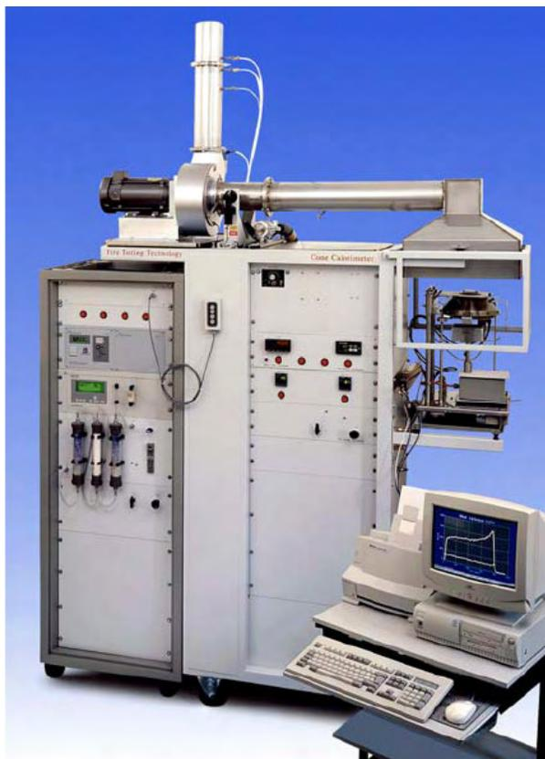
Figura 3.2 – Calorímetro de cone – visão geral do equipamento (HIRSCHLER, 2006).
