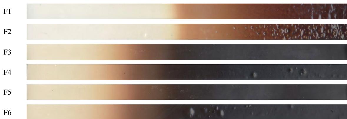
Figura 4.11 – Resultados visuais de estabilidade térmica estática das formulações de PVC/O-MMT: 1 hora a 230°C.
