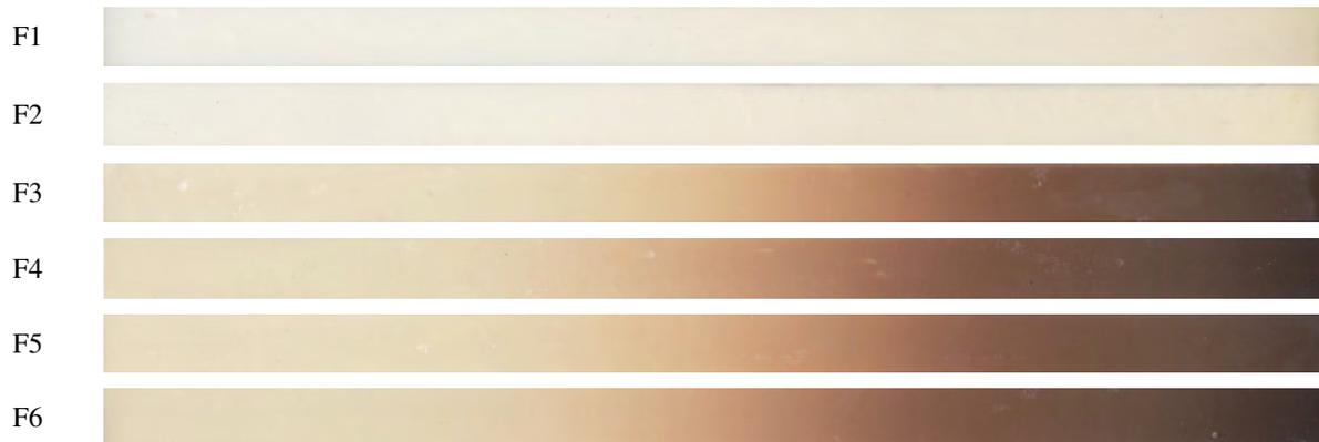
Figura 4.9 – Resultados visuais de estabilidade térmica estática das formulações de PVC/O-MMT: 1 hora a 190°C.
