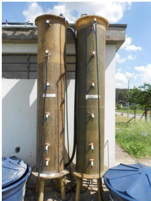
**Figura 29** – RBLM e biofiltro anóxico operando após instalação
