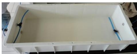
**Figura 15**– Unidade de *wetland* construído vazio (caixa plástica).
