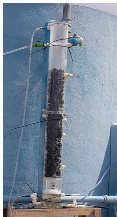
Figura 7.19a – Câmara de Dessorção com Preenchimento – Piloto
