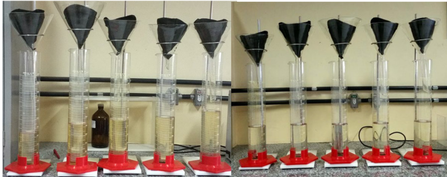
Desaguamento lodo UASB (multifamiliar).
