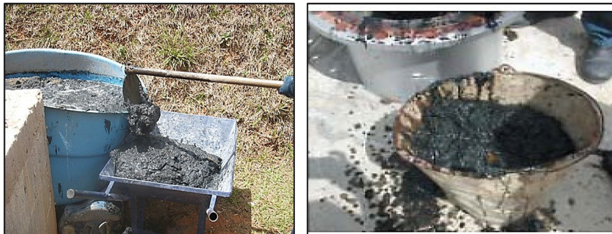
Figura 6.5 – Visualização do aspecto da espuma removida do interior de separador trifásico de reator UASB
