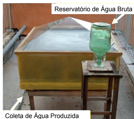
Figura 36 - Destilador solar em forma de pirâmide com cobertura de vidro.
