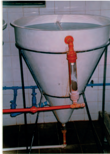
Figura 35 - Cone de saturação.
