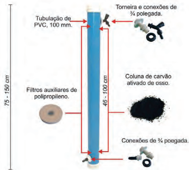
Figura 37 - Diagrama do sistema de filtração.
