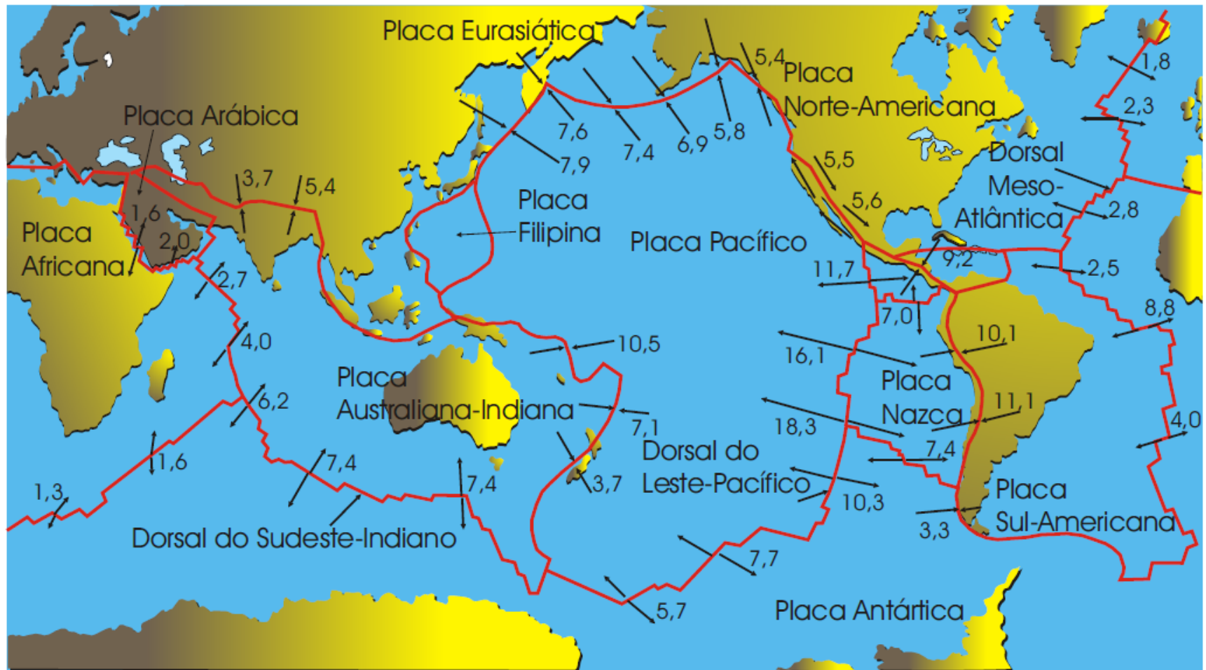
Fig. 6.5 Distribuição geográfica das placas tectônicas da Terra. Os números representam as velocidades em cm/ano entre as placas, e as setas, os sentidos do movimento.
