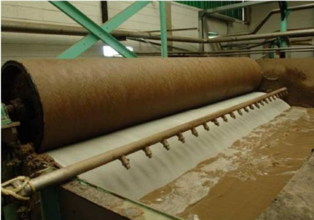
Em seguida é acrescida de água efetuando-se a **desagregação**, isto é, a **matéria-prima é transformada em pequenos pedaços de papel**, formando uma suspensão fibrosa chamada de **massa**.
