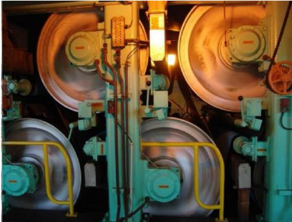
Ao sair desta seção, o **teor de sólidos do papel aumenta para cerca de 90 a 95%**. O produto passa por uma série de cilindros de secagem aquecidos, onde atinge **umidade da ordem de 8%**.
