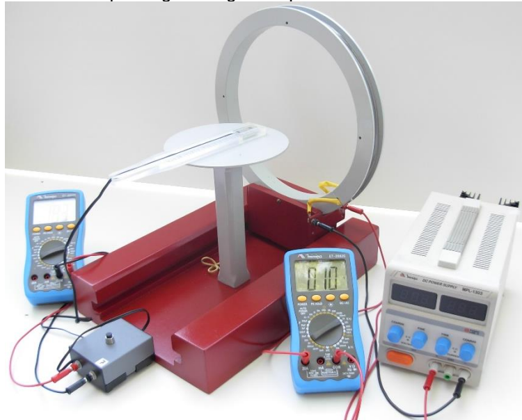
Figura 0.14 - Medida do campo magnético gerado pela bobina usando uma sonda Hall
