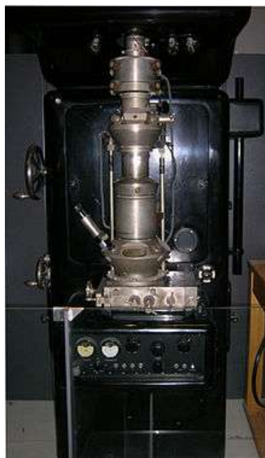
O primeiro MET, instalado na I. G Farben-Werke, desenvolvido de 1928 a 1931. Hoje no Deutches Museum em Munique. À direita o esquema de Ernst Ruska de um protótipo.
