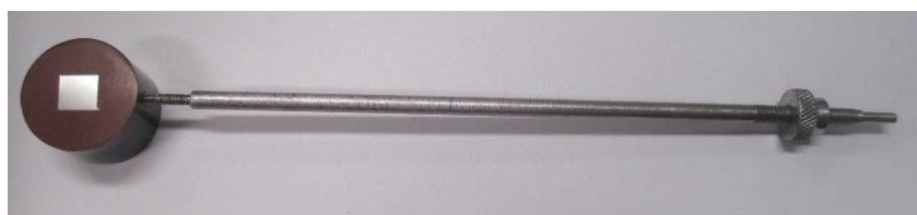
Amostra embutida e com contato elétrico com haste de aço inoxidável parafusada. A haste deve ser parafusada até haver contato elétrico com a amostra. (Fonte: Dissertação de Janeth Marlene Quispe-Avilés. PMT-EPUSP. 2017.)
