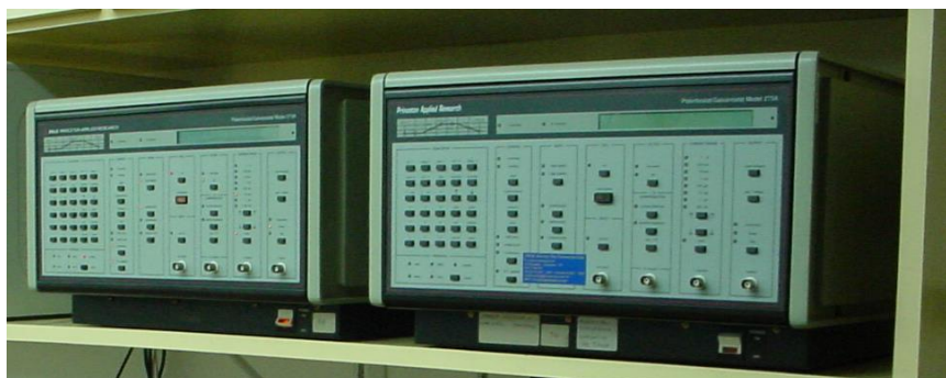
Potenciostato utilizado para obtenção de curvas de polarização. Existem diversos modelos disponíveis. Atualmente, alguns dele cabem na palma da mão. (Fonte: dissertação de Rodrigo César Nascimento Liberto. PMT-EPUSP. 2004.)
