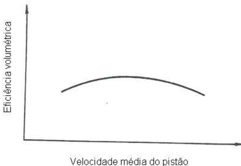
Figura 4.1 Efeito da velocidade do pistão sobre a eficiência volumétrica
