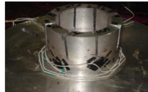
**Figura 17.** Detalhe dos extensômetros no dispositivo de ensaio.
