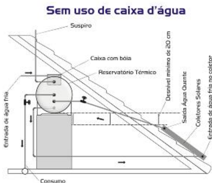
Figura 1 - Esquema de sistema de aquecimento com abastecimento direto da rede pública de água. Fonte: Aquecemax: www.aquecemax.com.br/instalacoes .
