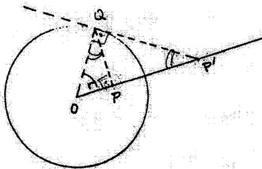
Supondo  $r \leq 1$ , por  $P$ , traçamos uma das semi-retas perpendiculares a  $OP$  que corta o círculo unitário num único ponto  $Q$ . Traçemos a reta tangente ao círculo por  $Q$ . Esta intercepta a reta  $OP$  num ponto  $P'$ . Então,  $\overline{OP'} = \frac{1}{r}$ . De fato, os  $\Delta$ s  $OPQ$  e  $OQP'$  são semelhantes quando  $r < 1$ . Observe que quando  $r = 1$ ,  $P = Q = Q'$
