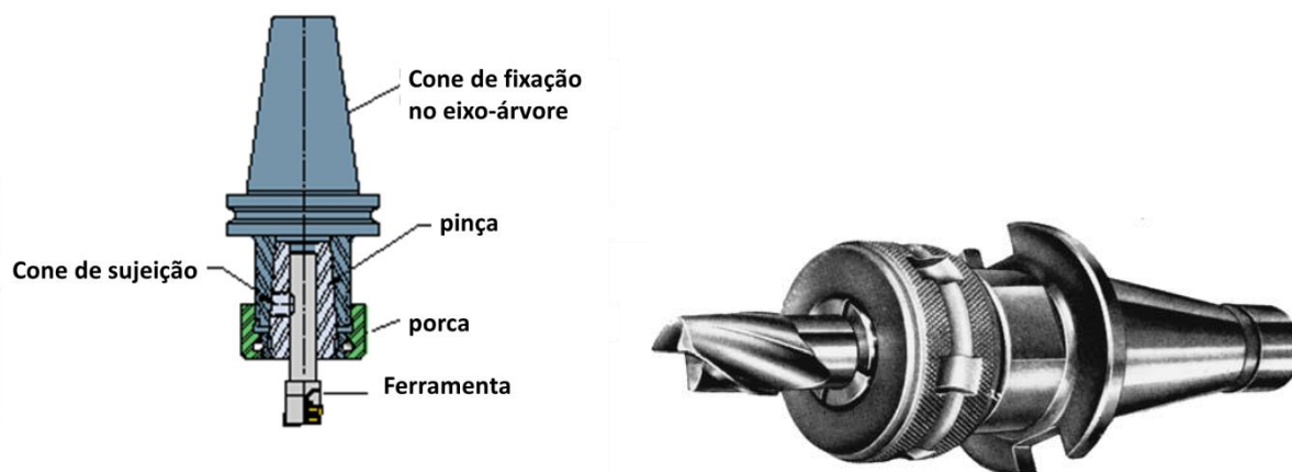
Figura 2.9 – Exemplo de fixação da fresa por meio de pinça.
