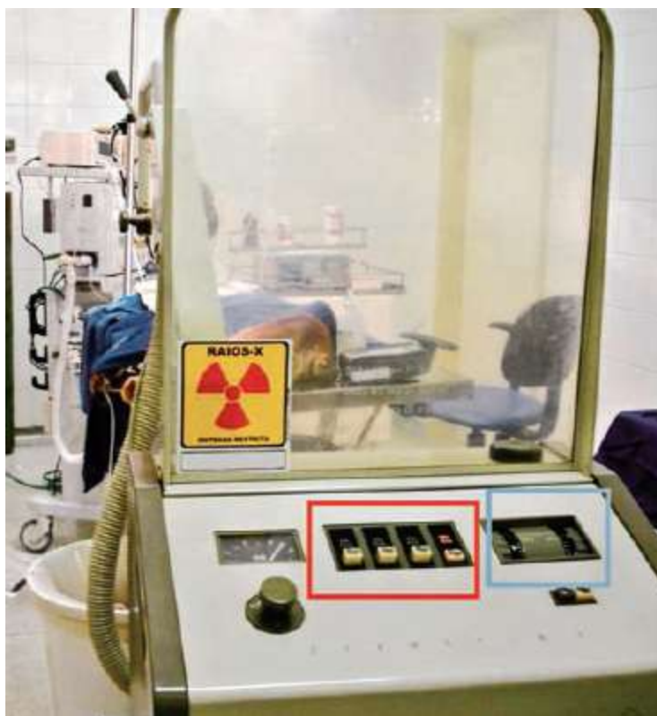
Figura 62.21 Equipamento de radioterapia superficial – Dermopan ® 2. Notar área destacada em vermelho , onde se seleciona a energia do feixe e tempo de radiação ( azul ).
