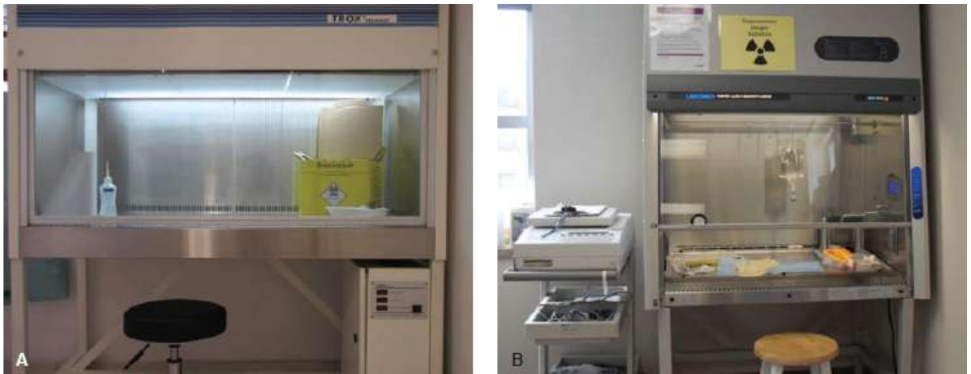
Figura 58.1 Capelas de fluxo laminar vertical classe II B2 para manipulação de quimioterápicos no Serviço de Oncologia Veterinária do Provet, São Paulo, Brasil (A) e no Animal Cancer Center, Calgary, Canadá (B).
