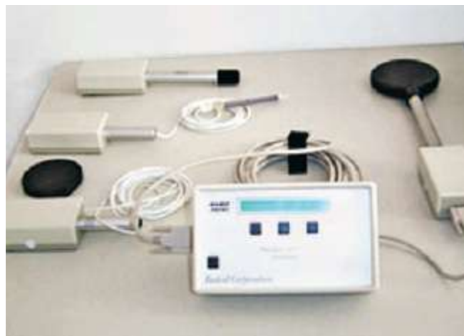
Figura 62.1 Câmaras de ionização usadas no controle de qualidade dos feixes de radiação.
