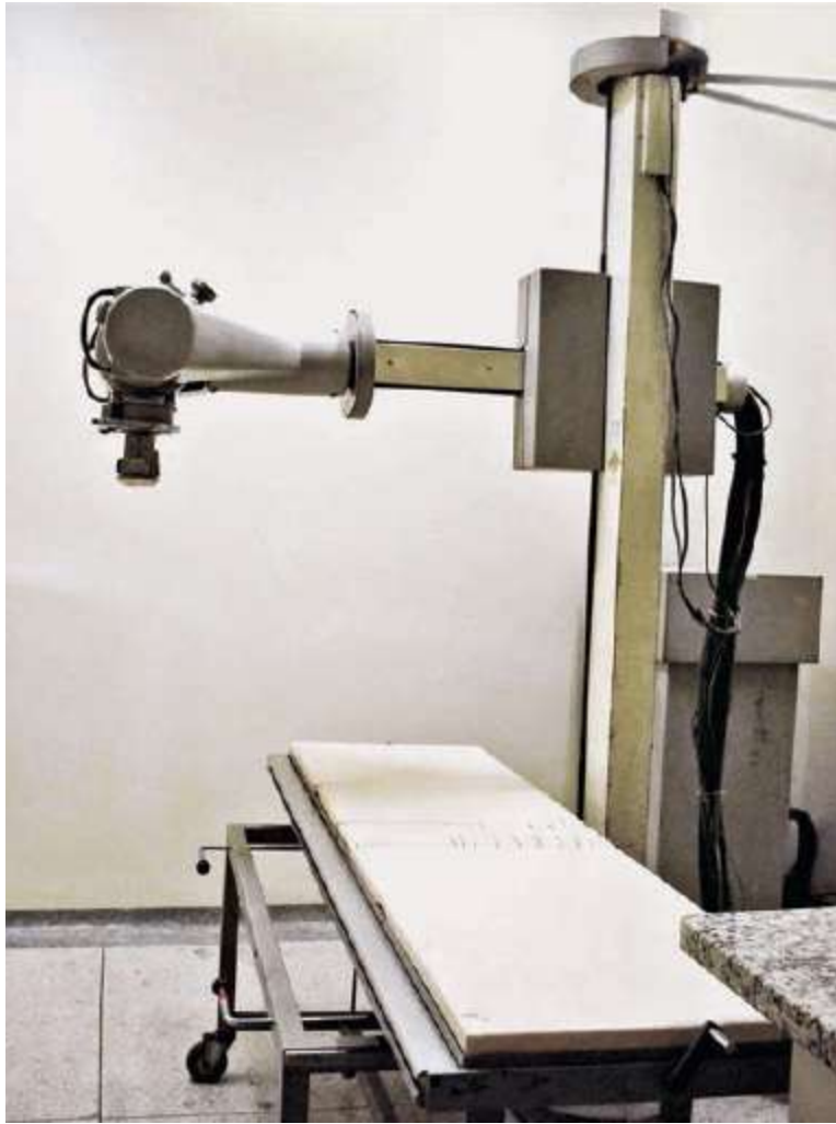
Figura 62.22 Equipamento de radioterapia de ortovoltagem – Stabilipan®.
