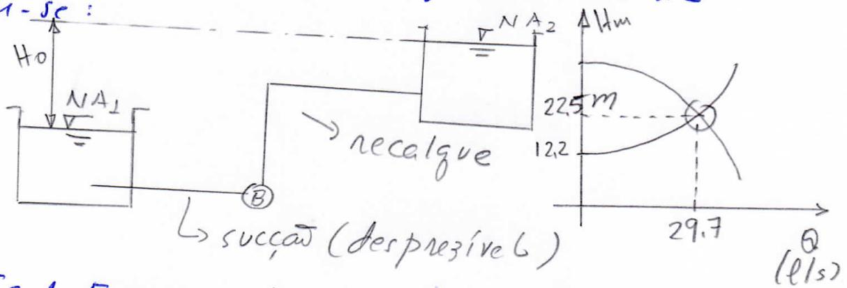
$$\text{Eg. da Energia: } H_1 - H_2 = h_{f1-2} - H_B$$
