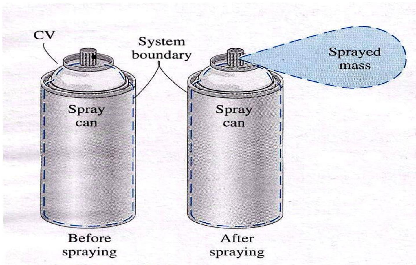
Uma lata de spray pode ser analisada de duas formas: acompanhando o conteúdo da lata (Lagrange- sistema fechado: massa não varia, ou seja, após spray a fronteira do sistema inclui a massa fora da lata) ou monitorando o volume da lata (Euler - volume de controle: só a lata, antes e depois)
