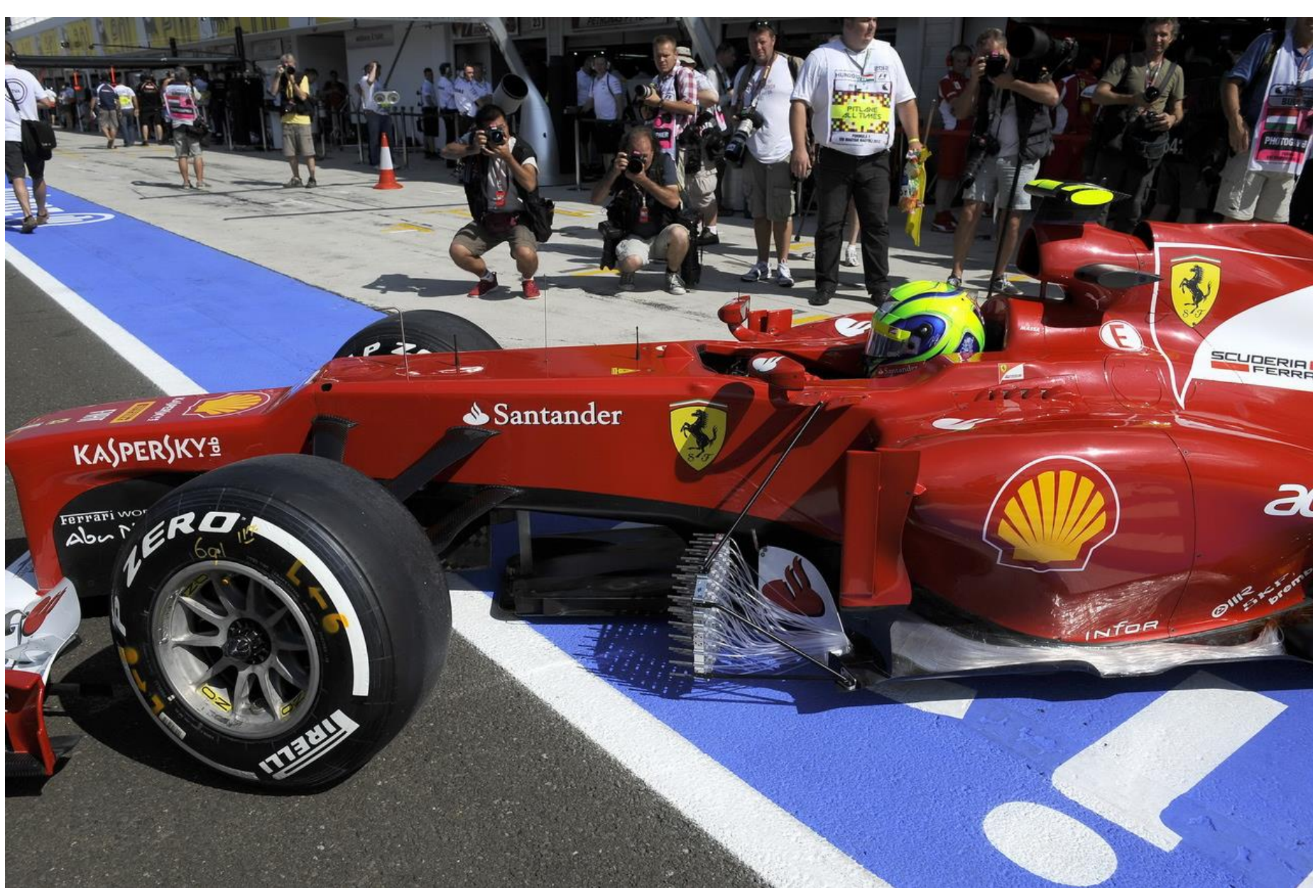
Matriz de tubos de Pitot atrás da roda, para determinar o campo de velocidades
