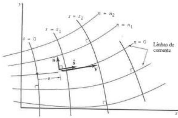
Pode ser conveniente usar um sistema de coordenadas definido em função das linhas de corrente, com vetores  $\vec{s}$  e  $\vec{n}$
