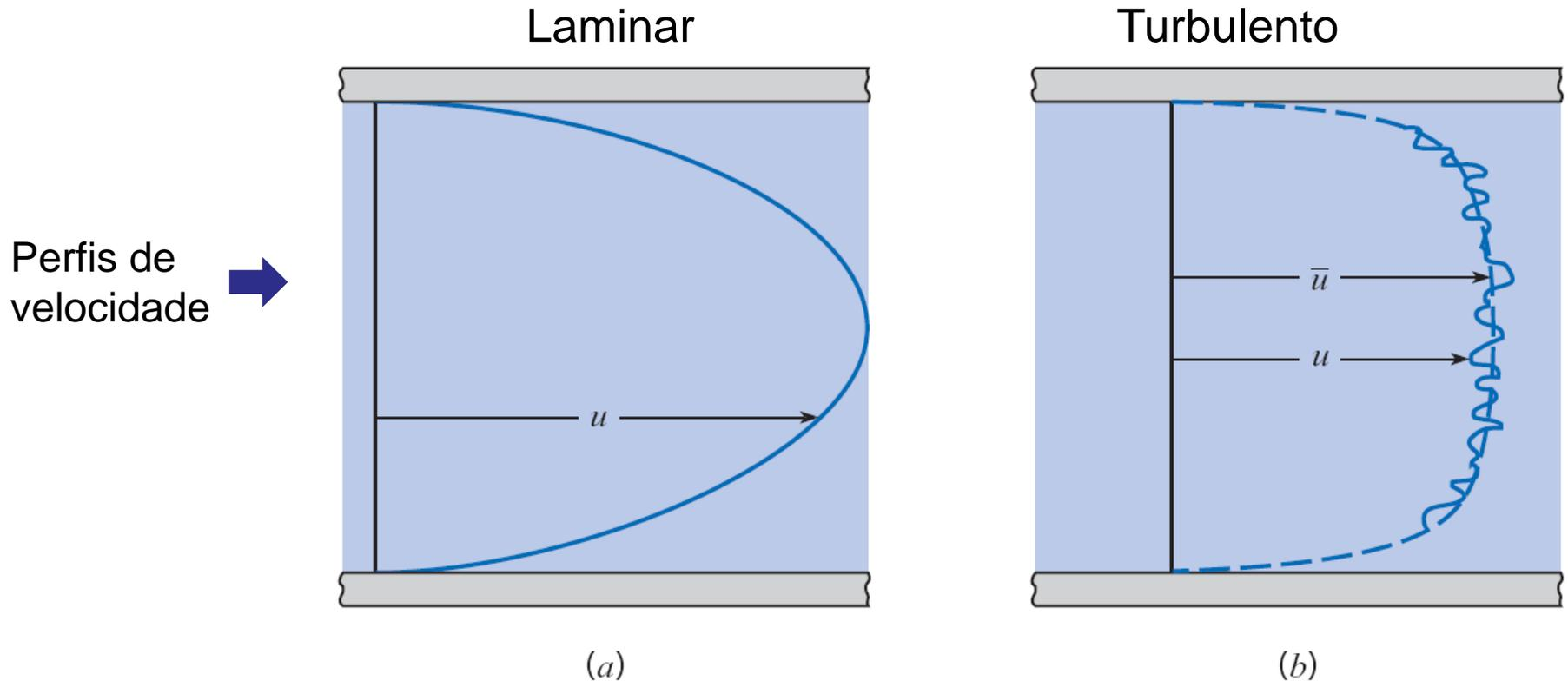
O escoamento laminar tem a forma parabólica.
