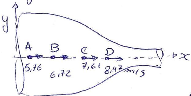
$$\text{aceleração} \Rightarrow \vec{a} = \frac{d\vec{V}}{dt} = \frac{\partial \vec{V}}{\partial t} + (\vec{V} \cdot \nabla) \vec{V}$$
