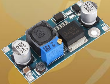
Figura 6: regulador de tensão LM2596 conversor DC-DC step down
