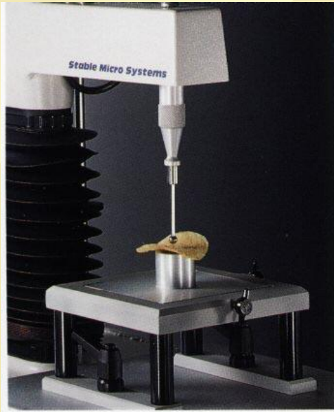
Fig. 12. Probes (crisp fracture support rig, disc plunger, three point bend rig) utilizados para batata frita, salgadinhos, géis, cremes, molhos, biscoitos, barras de chocolate, etc. As medidas são realizadas para a caracterização da fraturabilidade, viscosidade, força de quebra, entre outras.
