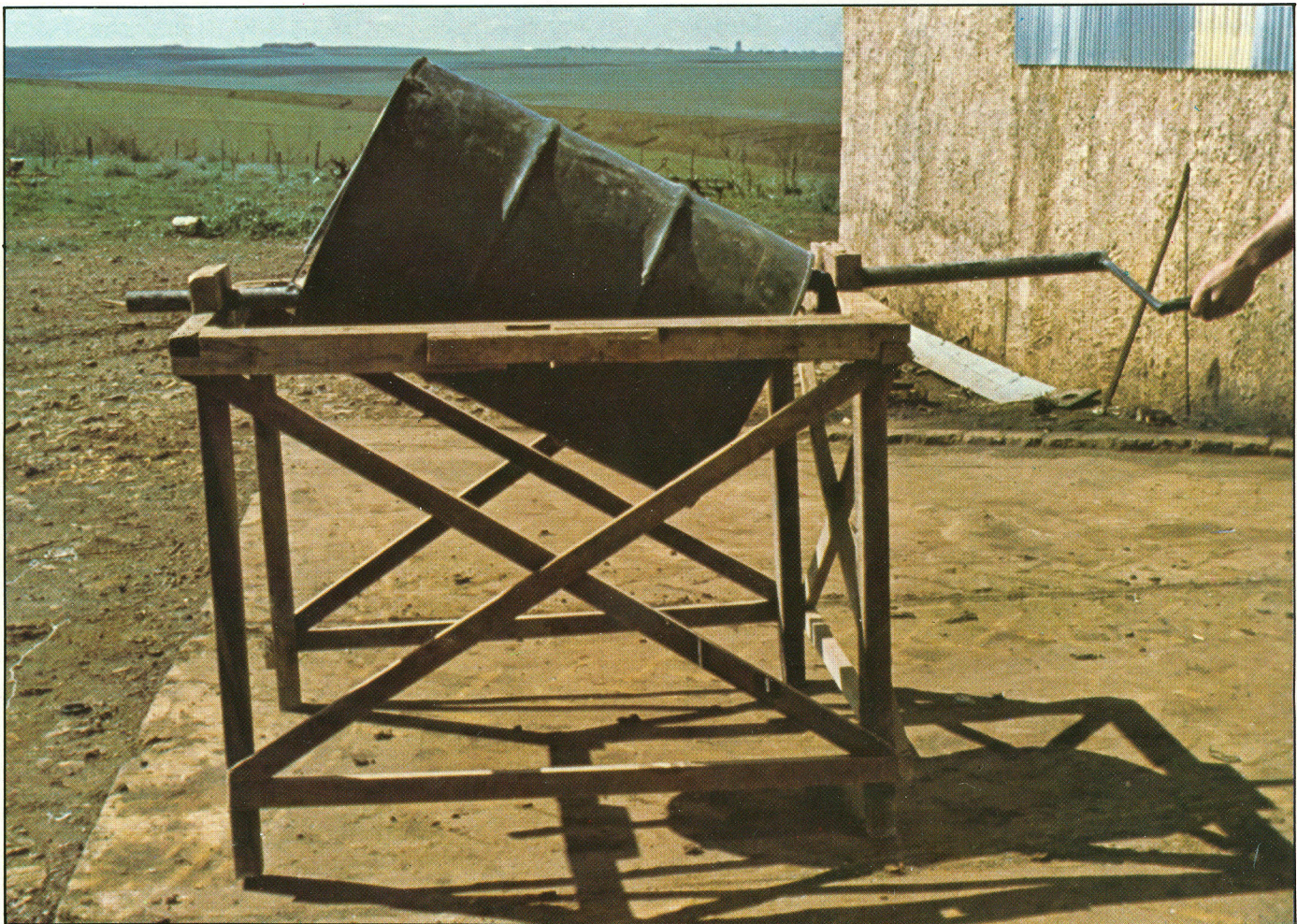
Figura 20. Tambor rotativo empregado no tratamento de sementes com fungicidas.
