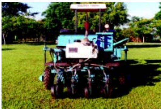
Fig. 1. Pulverizador Micron adaptado à semeadeira adubadeira, para aplicação de fungicidas nos sulcos.
