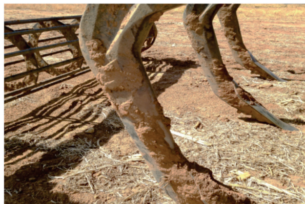
Figura 3. Implemento subsolador contendo grande quantidade de solo aderido, que pode introduzir altas populações de fitonematoides entre áreas.
