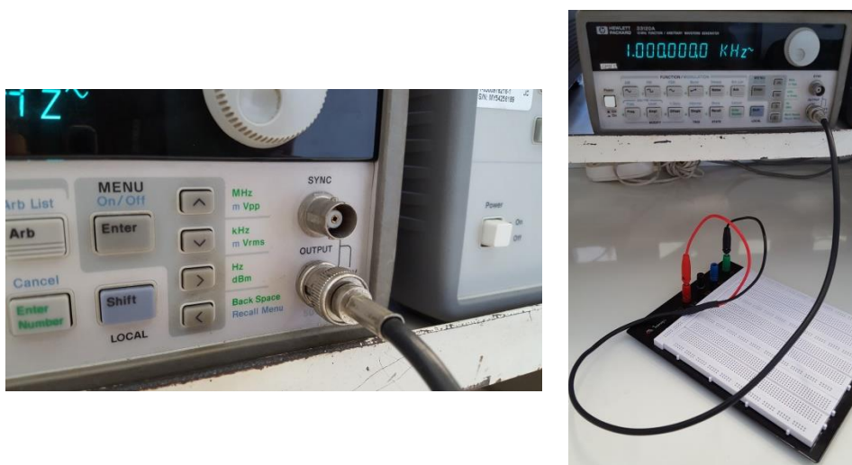
Figura 3: Cabo coaxial com conectores BNC-bananas utilizado na saída do gerador de funções.
