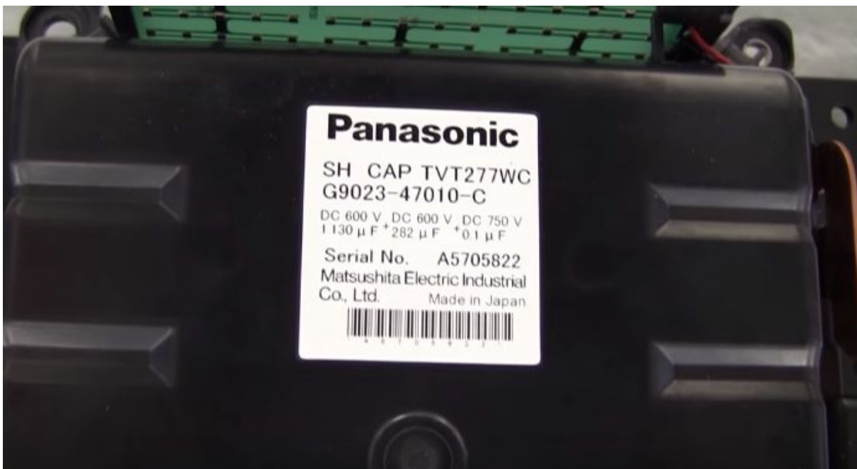
Figura 9.27 – Especificação do Pacote de Capacitores.
