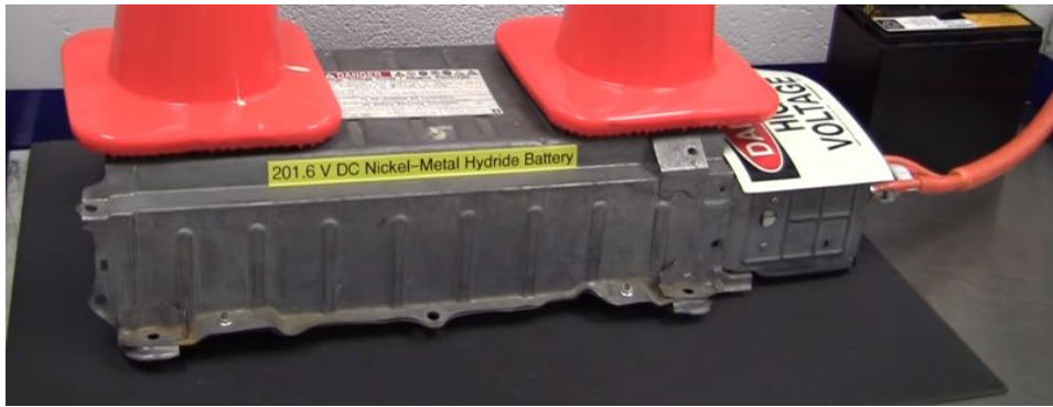
Figura 9.19 – Bateria de Alta Tensão visualização externa.
