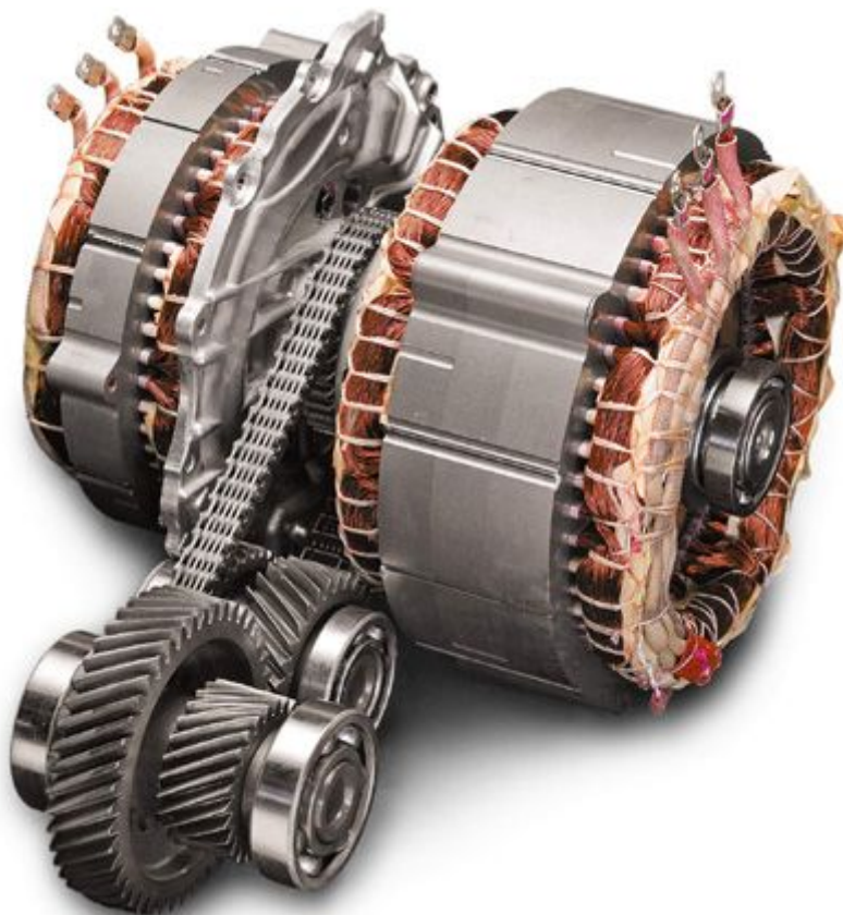
Figura 3.1: Motores-geradores do Prius conectados ao transeixo
