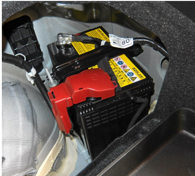
Figura 5.1.5 - Bateria auxiliar montada no Toyota Prius
